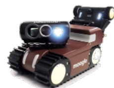
自走式床下点検ロボット
